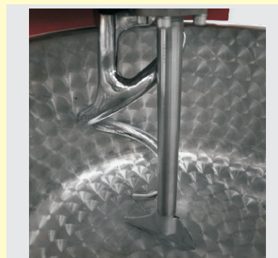
S-образный месильный орган и центральный отсекатель
