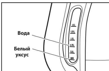
На внутренних металлических частях электрочайника может отложиться кальций. Для того, чтобы электрочайник работал максимально эффективно, следует периодически производить его очистку. Периодичность чистки зависит от жесткости воды, которую вы наливаете
